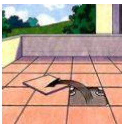
Hochfeste Kunststoff-Stützen als höhenverstellbare Unterkonstruktion
