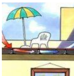
Hochfeste Kunststoff-Stützen als höhenverstellbare Unterkonstruktion
